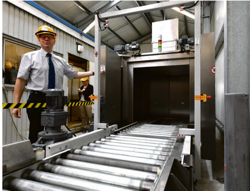
Georg Bacmeister, Leiter des Bereichs Entsorgung, im Atomkraftwerk in Brunsbüttel an einer Freimessanlage für Material das aus dem Kraftwerk nach Außen gelangen soll. Foto: Carsten Rehder, dpa
